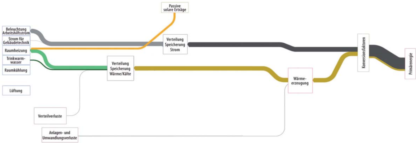
Abbildung 1: Energieflussdiagramm Messung Amtshaus Bruck an der Mur – Finanzamt/BEV Grafik auf Basis der vom Leitprojektmanagement zur Verfügung gestellten Daten
